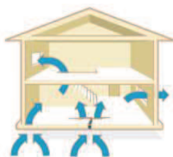
Drainage du radon par mise en dépression du sol sous-jacent au bâtiment.
